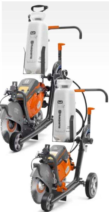
Conçus spécifiquement pour les découpeuses portatives thermiques. Les chariots permettent de découper facilement en ligne droite ou en courbe, au plus près des murs et des trottoirs. Le stabilisateur de carter assure le maintien de la machine dans le trait de coupe. Compacts et pliants, ils se transportent facilement.
