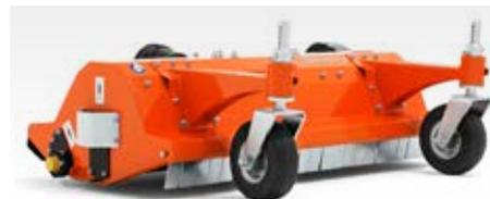
Tondobroyeur à fléaux entraîné par prise de force. Nouvelle conception avec engrenage conique renforcé, hauteur de coupe augmentée et performance améliorée dans la végétation dense. Les roues de support avant sont pivotantes et increvables. Largeur de travail 120 cm. Recommandé uniquement sur le P 525D. Exige un contrepoids.
