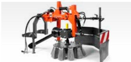
Brosse de désherbage entraînée par prise de force pour l'élimination efficace des mauvaises herbes et des saletés des trottoirs, caniveaux, surfaces pavées, etc... L'angle de la brosse est réglable depuis le siège. Diamètre 50 cm. Exige un kit hydraulique et un contrepoids.
